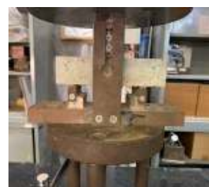
写真 5 曲げたわみ試験
